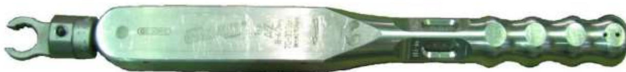
Рис. А.27 – Динамометрический ключ для затяжки гаек топливopроводов высокого давления. Дремометр №7460-01 AZ A+S (0,8-4,0кгсм) Ø 16мм + Вставная накидная насадка с открытым зевом № 8797-17, код 1211706, ф. Gedore.
