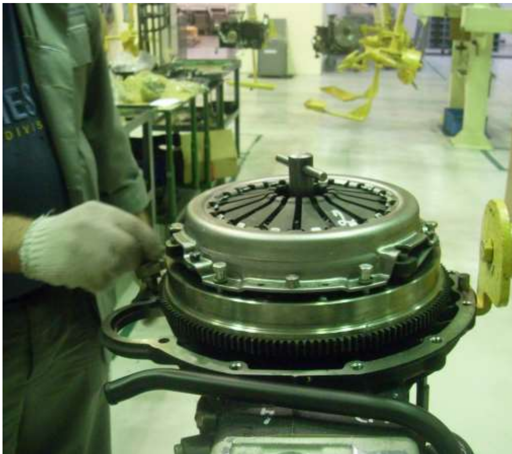
Установка фиксатора коленчатого вала ЗМ 7820-4550
