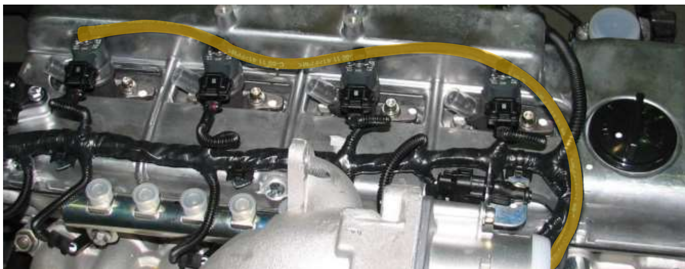
Рис. 58. Внешний вид топливопровода отсечного топлива.
