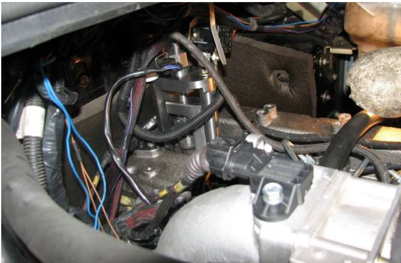
Извлечение форсунки с помощью съемника ЗМ 7823-4832 из головки цилиндров
