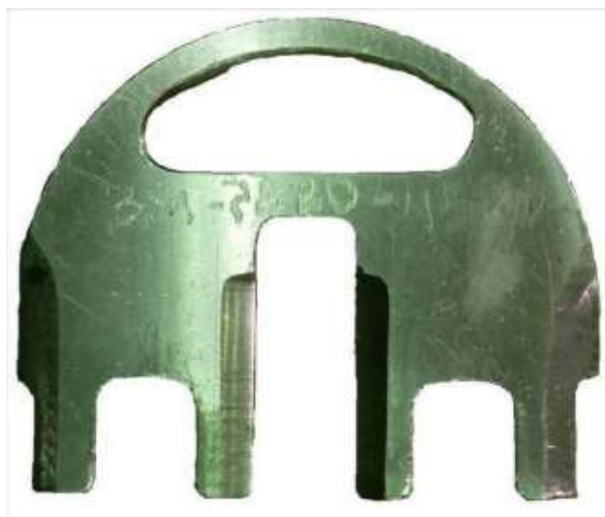
Рис. А.3 – Приспособление для фиксации распределительных валов 3М 7820-4580
