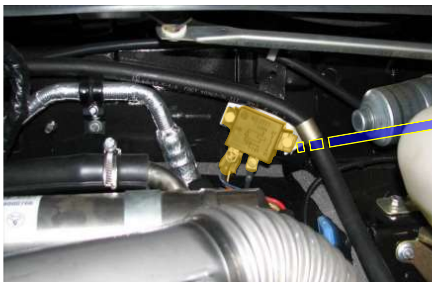
Рис. 98. Реле свечей накаливания 16.3777 (3151-48-3747040-00):
