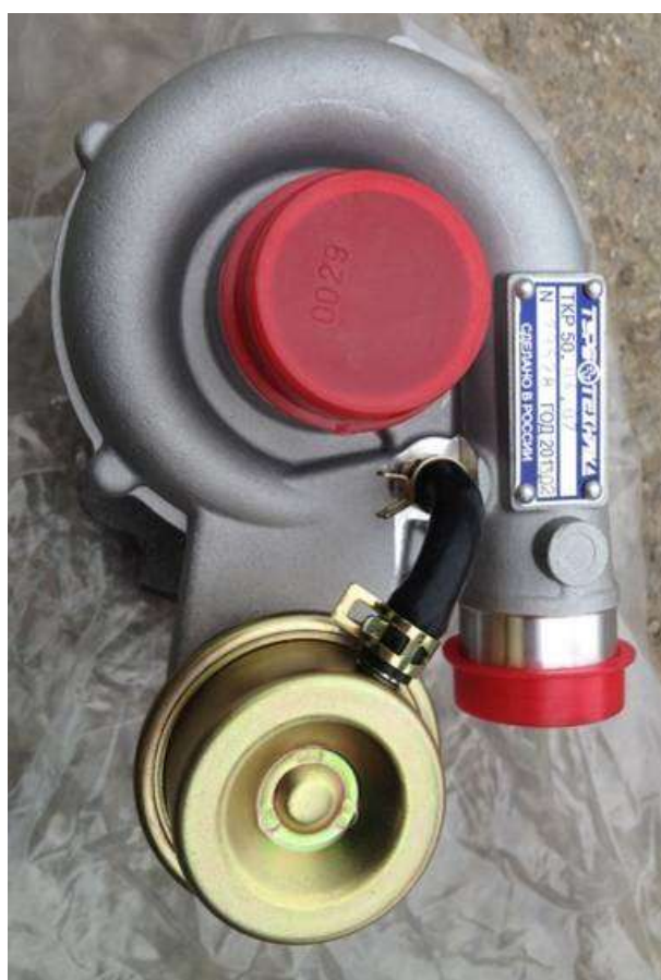
Содержание и расположение идентификационной таблички на ТКР 50.04.07
