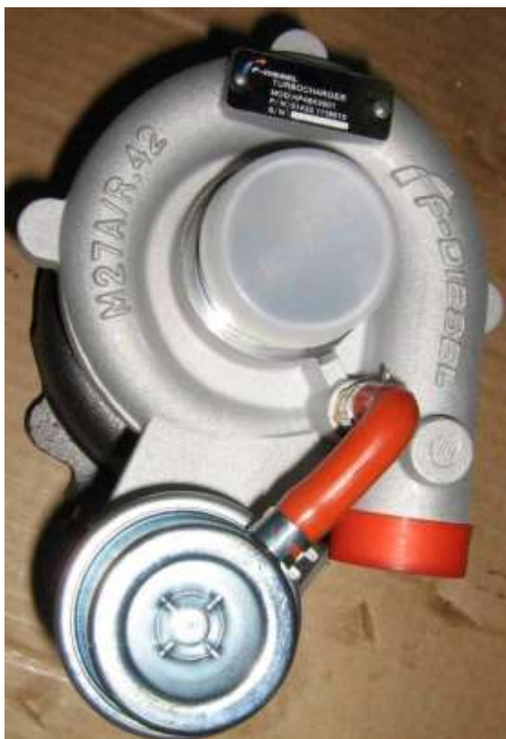
Содержание и расположение идентификационной таблички на ТКР HP48X3501
