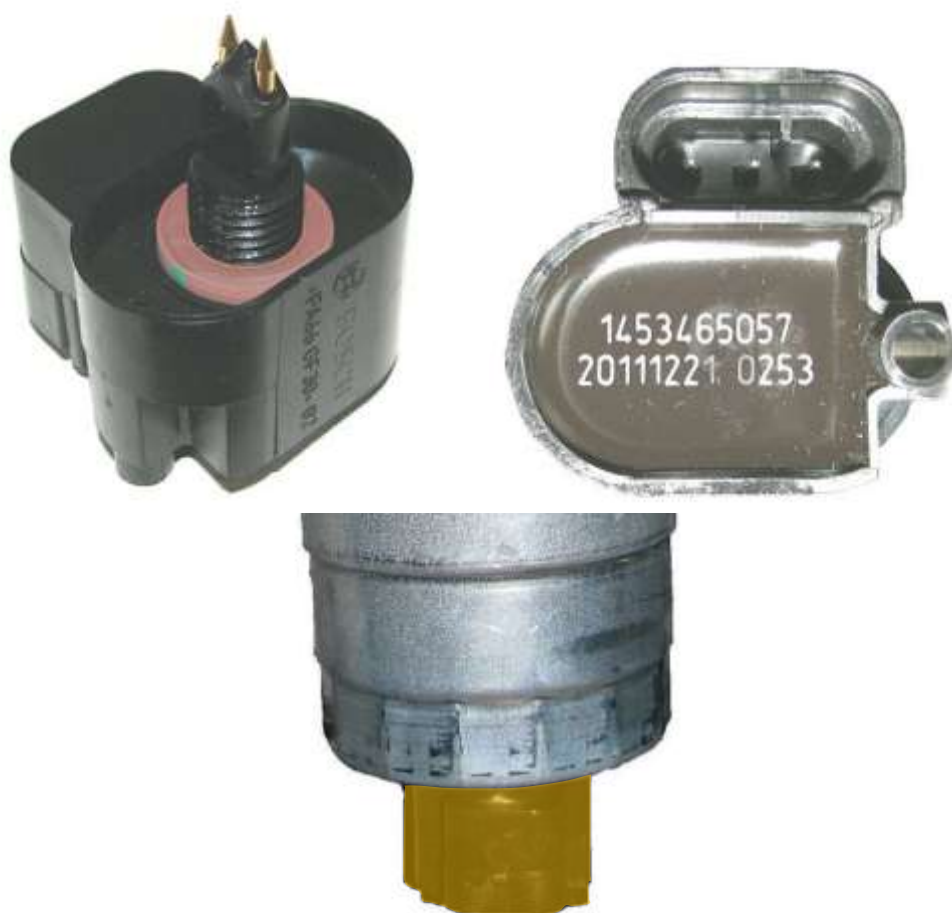
Рис. 89. Внешний вид и расположение датчика наличия воды
