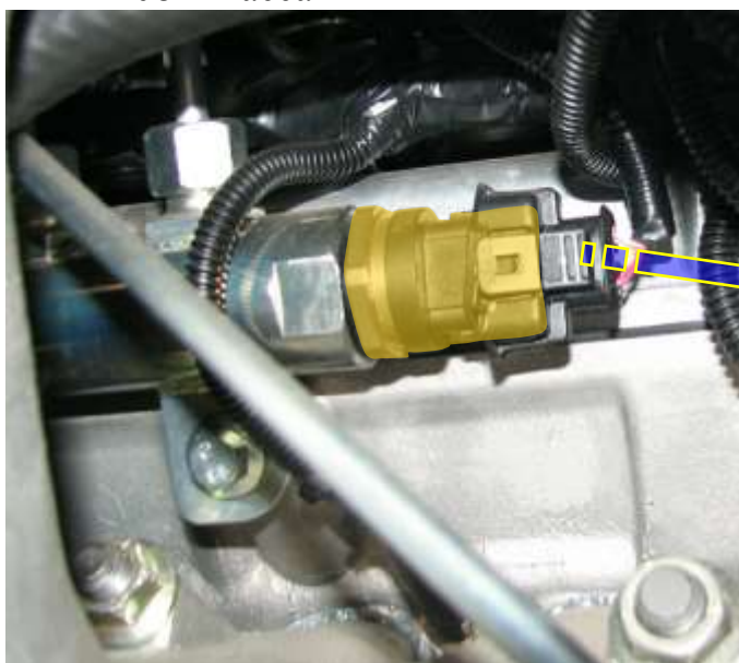
Рис. 91. Внешний вид и расположение датчика давления топлива
