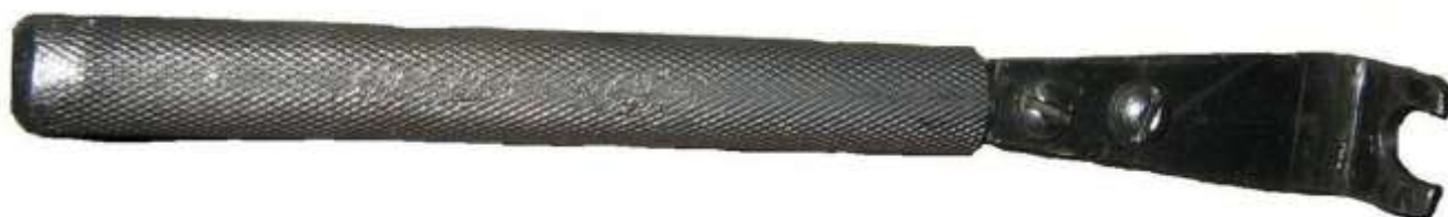
Рис. А.28 – ЗМ 7823-4655 Оправка для извлечения гидроопор из головки цилиндров
