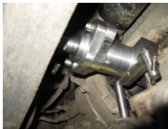
Рис. А.30 – 3М 7823-4815 Приспособление для снятия масляного картера установленного на герметик Loctite 5900
