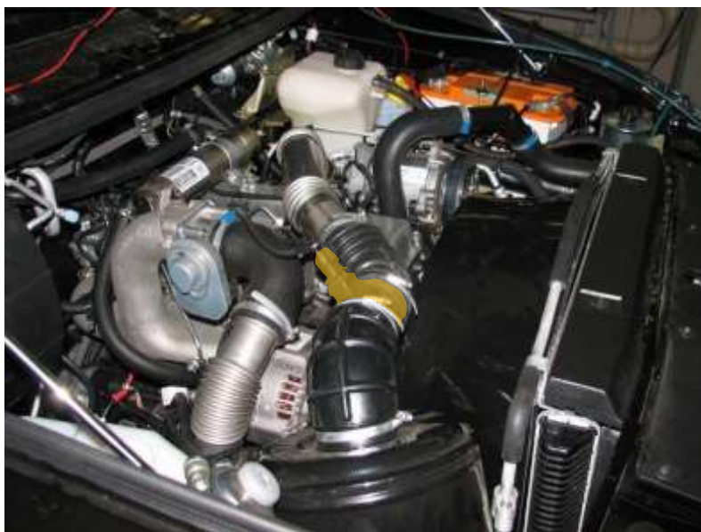
Рис. 84. Место размещения ДМРВ в системе впуска
