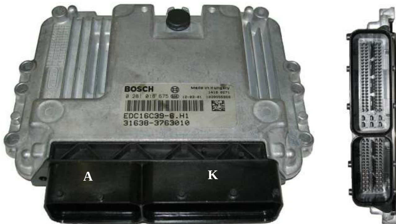
Рис. 78. Внешний вид ЭБУ модели EDC16C39-6.H1:
