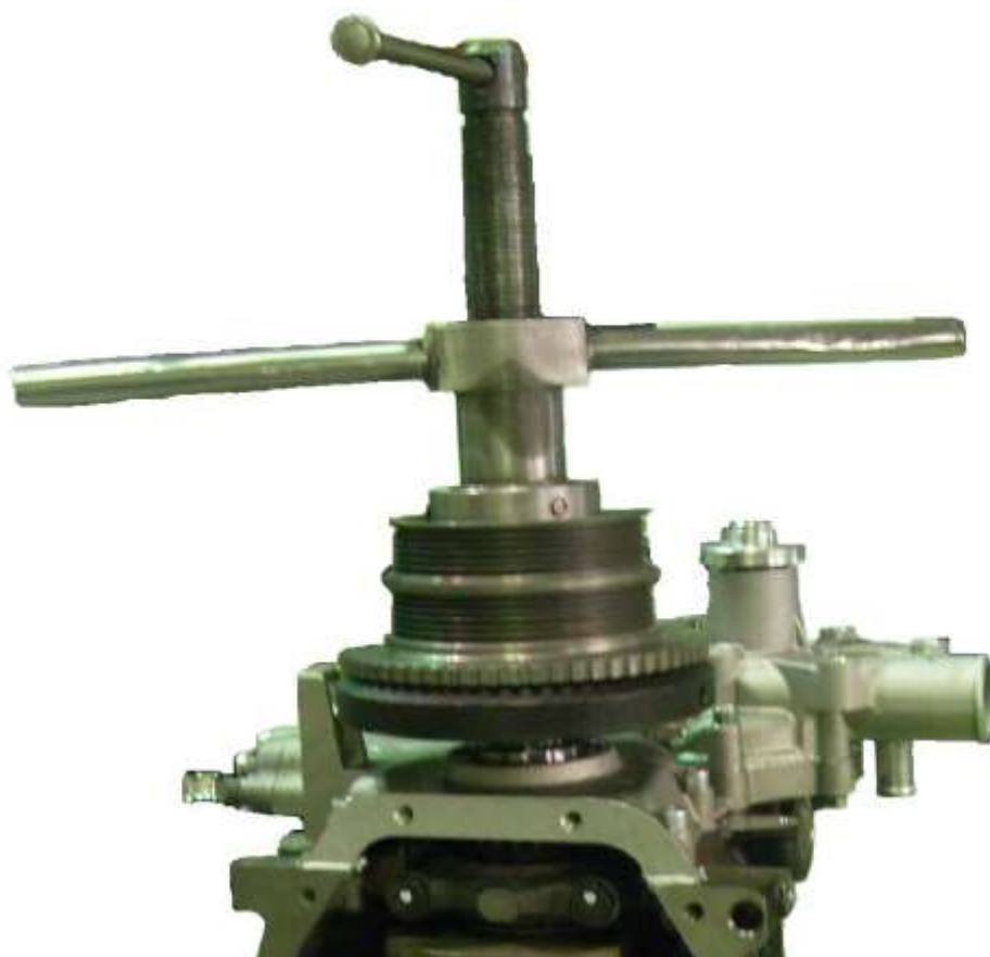
Применение приспособления 3М 7823-4291-04 для напрессовки шкива на коленчатый вал
