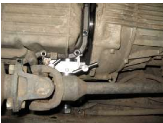
Рис. А.30 – 3М 7823-4815 Приспособление для снятия масляного картера установленного на герметик Loctite 5900
