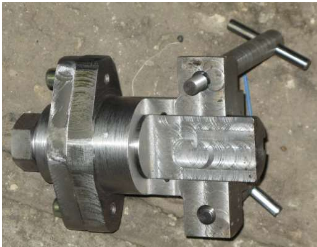
Рис. А.30 – 3М 7823-4815 Приспособление для снятия масляного картера установленного на герметик Loctite 5900
