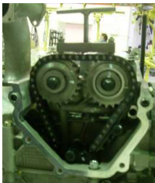
Применение приспособления ЗМ 7820-4579 для фиксации распределительных валов при сборке привода распределительных валов
