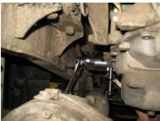
Снятие масляного картера установленного на герметик Loctite 5900 с помощью приспособления 3М 7823-4815
