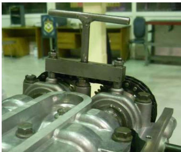
Применение приспособления ЗМ 7820-4579 для фиксации распределительных валов при сборке привода распределительных валов
