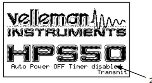
Долгое нажатие на кнопку приведет к включению питания прибора в режиме непрерывной работы (2).
