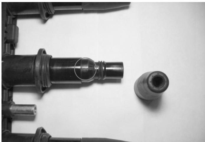
Плоскую отвертку вставляем в прорезь, разводим концы и, поворачивая по часовой стрелке, выводим из зацепления и снимаем внешний защитный экран.
