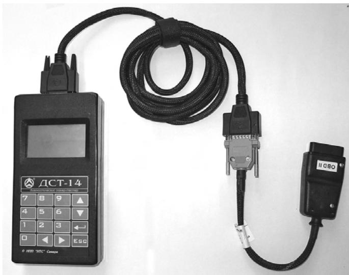
Все диагностические кабели следует подключать к автомобилю при помощи кабеля-удлинителя Д14-Д12-ДИАГ, обеспечивающего удобную длину подключения. Присоедините один раз кабель-удлинитель Д14-Д12-ДИАГ к DST-14, и при смене типа автомобиля меняйте только кабель-адаптер. Это быстро и удобно!
