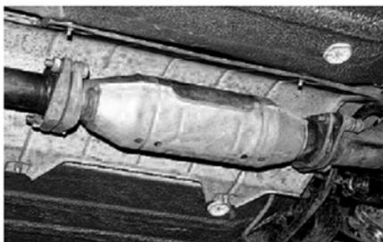
Нейтрализатор «Форда» (1,6 л, 115 л.с.) с двумя бачками: один для цилиндров 1 и 4, другой – 2 и 3. Из-за пропусков воспламенения по вине катушки зажигания разрушился керамический носитель. В поиске неисправности помог второй датчик кислорода, на выходе из нейтрализатора. Так как последний едва работал, сигналы с первого и второго датчиков кислорода почти совпадали по амплитуде, и блок управления зафиксировал ошибку.
