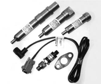
Для измерения компрессии, угла впрыска и наблюдения за процессами в системе газораспределения автомобилей с дизельными ДВС. В зависимости от конструкции двигателя датчик через дополнительные переходники устанавливается вместо форсунки, либо вместо свечи накалывания. В состав комплекта входят переходники для ЗиЛ 5301, КАМАЗ, МАЗ.
