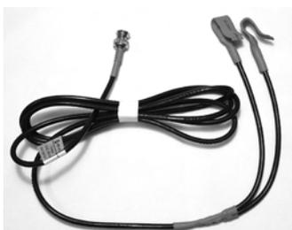
Емкостные датчики высокого напряжения во вторичных цепях зажигания: двойной красный и двойной чёрный для подключения к системе с двухвыводными катушками.
