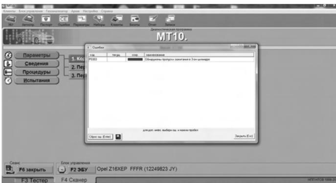
Зафиксирована ошибка P0303-Обнаружены пропуски зажигания в 3-м цилиндре. Необходимо проверить блок зажигания (БЗ) разрядником P1-2С.
