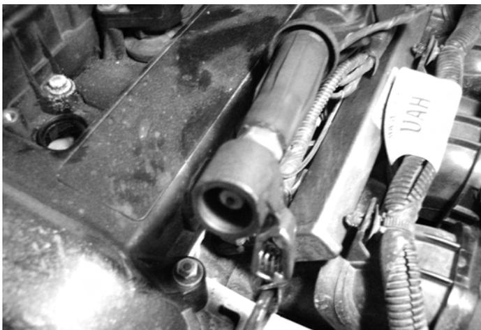
Выворачиваем свечу из первого цилиндра, вместо нее – компрессометр.
