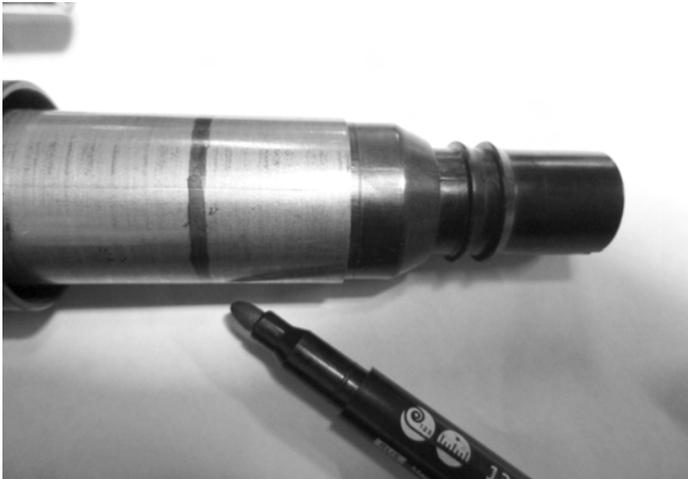
Пропиливаем надфилем часть внутреннего экрана и удаляем его.
