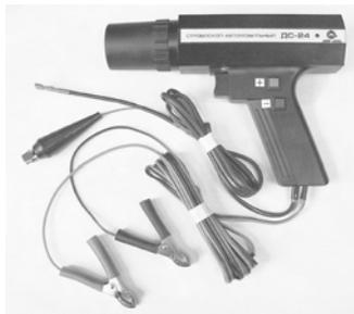
ДСУ-2 предназначен для измерения угла опережения впрыска топлива и оборотов дизельного двигателя для автомобилей с бортовым питанием 12В и 24В, а также для проверки работоспособности регулятора опережения впрыска топлива. Предназначен для диагностики только дизельных автомобилей. В комплект поставки стробоскопа ДС-24 (ДС-12) входят пьезодатчики ПД-4 и ПД-6.
