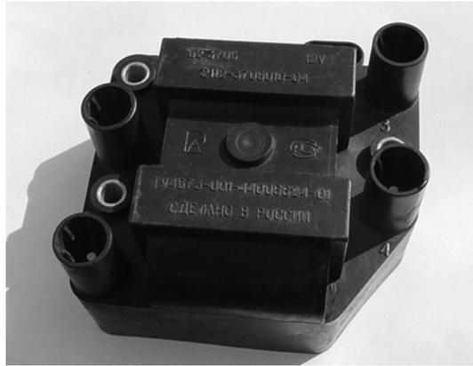
Модуль зажигания отвечает в системе за формирование высоковольтного напряжения на свечах зажигания. Модуль включает в себя высоковольтные ключи (коммутатор и 2 катушки зажигания). Блок управления формирует для модуля низковольтные управляющие сигналы, согласованные с положением коленчатого вала. Конеч сигнал определяет начало искрового зажигания, длительность определяет степень заряда катушки и зависит от напряжения бортовой сети.
