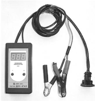
Компактные и простые в управлении приборы с цифровой индикацией положения регулятора холостого хода. Тестер ДХХ-2ВАЗ предназначен для определения работоспособности регулятора холостого хода автомобилей ВАЗ, оснащенных инжекторными двигателями. Тестер ДХХ-4ГАЗ предназначен для определения работоспособности регулятора холостого хода автомобилей ГАЗ, оснащенных инжекторными двигателями.
