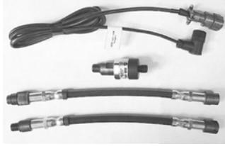
Датчик давления ДД-10М для измерения компрессии, угла опережения зажигания и наблюдения за процессами в системе газораспределения автомобилей с бензиновыми двигателями внутреннего сгорания. Датчик рассчитан на давление 25 бар; предельно допустимое давление составляет 50 бар. Датчик вкручивается в цилиндр вместо штатной свечи зажигания.
