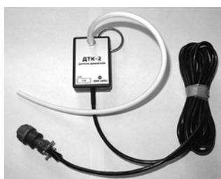
Датчик для измерения давления воздуха во впускном и выпускном коллекторе двигателя, давления наддува турбины, просмотра пульсаций давления. Позволяет определить работоспособность турбины двигателя, равномерность работы цилиндров, состояние катализатора выхлопных газов, состояние газораспределительного механизма. Может использоваться с переходником для турбокомпрессора КАМАЗ.
