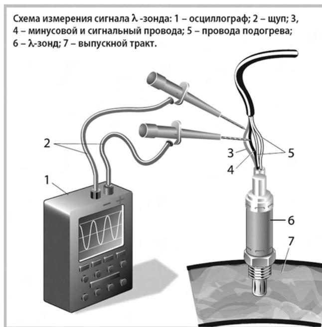
Итак, блоку «не нравится» сигнал с датчика кислорода? Чтобы его проверить, специалист воспользуется мотор-тестером, сканером либо осциллографом. Цифровым вольтметром – в самом крайнем случае: работа с ним сложна, так как показания, зачастую не поспевающие за изменениями сигнала, не каждый умеет правильно читать. Мы будем говорить об измерениях мотор-тестером как наиболее удобном способе диагностики. Входное сопротивление перечисленных приборов не должно быть менее 1 МОм.
