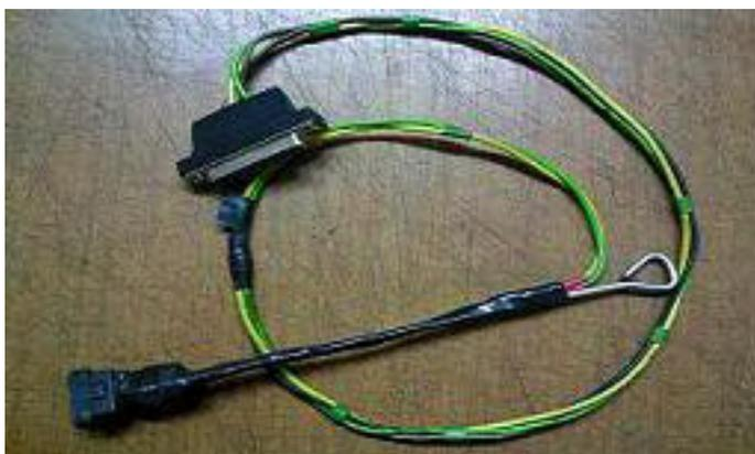
Примотанная к самодельному шнуру проволочная тяга от актуатора дверных замков, значительно облегчает подключение к форсункам на ГАЗовских моторах...
