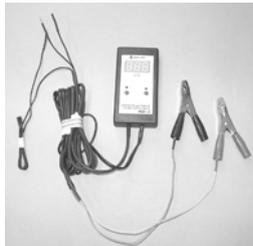
ИДК-2 предназначен для имитации датчика ДПКВ двигателей внутреннего сгорания с конфигурацией 58 зубьев с двумя пропущенными ("60-2"), датчика ДПРВ или датчика-распределителя зажигания (датчика Холла) и других аналогичных датчиков (например датчика скорости автомобиля). Имитация ДПКВ позволяет проверить функционирование системы зажигания автомобиля, форсунок и электронного блока управления.
