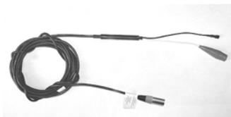
УЗ-ПМ используется для усиления сигнала с датчиков ПД-4, ПД-6 и последующей передачи усиленного сигнала в блок автомобильной диагностики АМД-4АКМ. Позволяет посмотреть форму сигнала давления в трубках топливной системы ТНВД дизельных двигателей и сделать выводы о работоспособности ТНВД и форсунок, определить угол момента впрыска и длительность открытого состояния форсунок.
