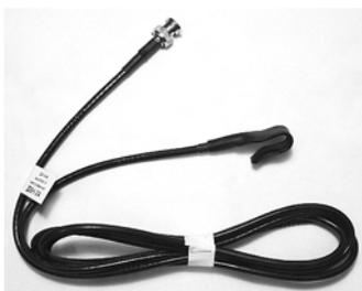
Емкостной датчик высокого напряжения во вторичных цепях зажигания одиночный чёрный. Для подключения к классической системе зажигания с одной катушкой и распределителем.
