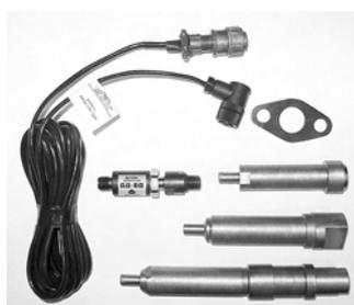
Датчик давления ДД-8Д для измерения компрессии, угла впрыска и наблюдения за процессами в системе газораспределения автомобилей с дизельными двигателями внутреннего сгорания. В зависимости от конструкции двигателя датчик через дополнительные переходники устанавливается либо вместо форсунки, либо вместо свечи накаливания. В состав комплекта входят переходники для подключения к двигателям:
