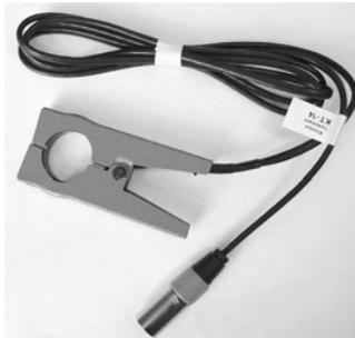
Клещи для измерения постоянного/переменного тока +/-250 А. Для наблюдения формы стартерного тока в режиме прокрутки, тока зарядки аккумулятора.
