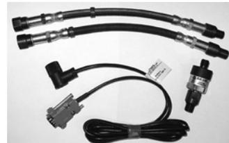
Для измерения компрессии, УОЗ и наблюдения за процессами в системе газораспределения автомобилей с бензиновыми ДВС. Датчик рассчитан на давление 25 бар; предельно допустимое давление составляет 50 бар.
