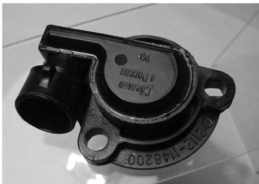
Располагается на узле дроссельной заслонки и определяет степень открытия дроссельной заслонки. Система использует показания датчика дроссельной заслонки для следующих режимов работы:
