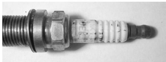
Пробой свечи по изолятору - замена свечей зажигания
