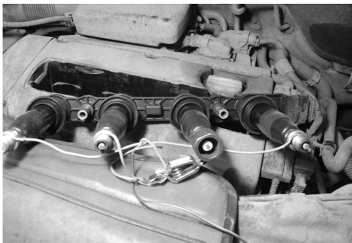
Компрессия есть, искры-нет. Если вовремя не менять свечи, то выходит из строя блок зажигания. Как видно, свеча со следами сильного износа.
