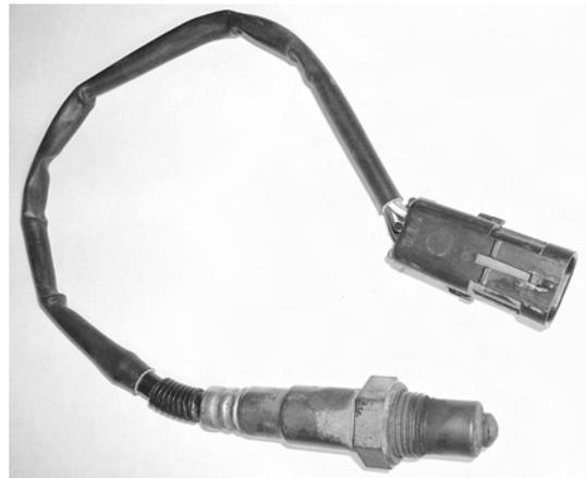
Датчик кислорода установлен в выпускной системе двигателя и служит для определения наличия кислорода в отработавших газах. На поверхности датчика происходит реакция окисления несгоревшего топлива, эта поверхность служит своего рода катализатором этой реакции. Специальный слой на поверхности датчика способен отдавать или восстанавливать ионы кислорода. Разность концентрации кислорода в атмосферном воздухе и на поверхности датчика и является причиной меняющегося выходного напряжения датчика.
