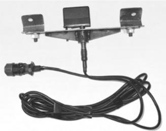
Используется в диагностике дизельных двигателей КАМАЗ для привязки сигналов с других датчиков к углу поворота коленвала диагностируемого двигателя.
