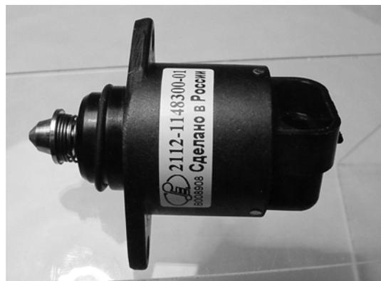
Шаговый мотор установлен в байпасном канале узла дроссельной заслонки. Положение вала шагового мотора определяет проходное сечение байпасного канала, необходимое для устойчивой работы двигателя при закрытой дроссельной заслонке. В системе управления шаговый мотор выполняет несколько основных функций:
