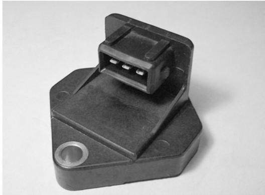
Датчик неровной дороги (ДНД) расположен в моторном отсеке, как правило, на стойке передней подвески. Датчик предназначен для измерения колебаний кузова. Принцип его работы – работа пьезодатчика.
