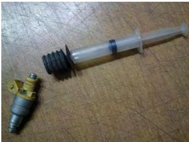
Для начала в резиновой пробке от Шнивы, со стороны шляпки, пилом прокалываем отверстие, куда и вставляем штуцер шприца. С другой стороны, предварительно сняв резиновое кольцо, вставляем форсунку.
