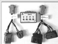
Специализированные тестеры: тестер модулей зажигания ТМЗ-2М, тестер катушек зажигания ТКЗ-2М, тестер регулятора оборотов холостого хода ДХХ-2ВАЗ. Средства диагностики форсунок: компактные тестеры форсунок ТФ-6, индикатор форсунок ИФ-8.
