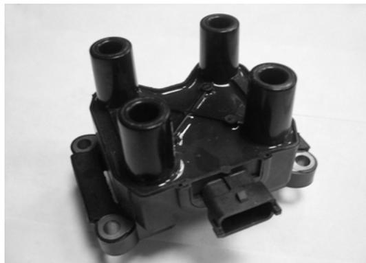
На современных системах модуль зажигания устанавливаются четырехвыводные катушки зажигания.
