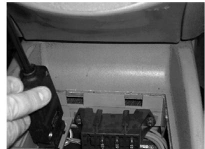
6. Подключить индикатор форсунок ИФ-6К. Для этого необходимо разъединить разъем жгута форсунок и подключить колодки индикатора в соответствии со штатными колодками
