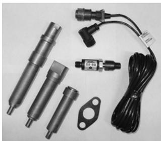
Датчик для измерения компрессии, УОЗ и наблюдения за процессами в системе газораспределения, а также для измерения давления топлива. Датчик рассчитан на давление 40 бар; предельно допустимое давление составляет 80 бар. Устанавливается вместо форсунки или свечи накалывания. Поставляется с переходниками для ЗИЛ, КАМАЗ, МАЗ..
