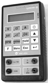
УММ-2 предназначен для измерения параметров электрических сигналов и физических параметров агрегатов автомобиля: постоянного напряжения, постоянного тока, сопротивления, проверки состояния диодов, напряжения во вторичных цепях зажигания, оборотов двигателя и УЗСК (угол замкнутого состояния контактов).
