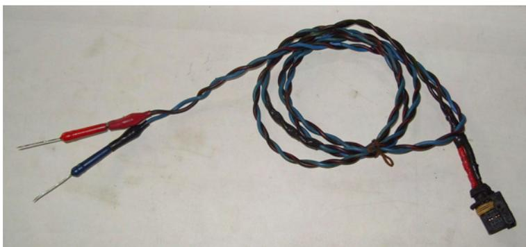
Посредством этого штатный жгут был «исключён» из управления четвёртой форсунки. На таком подсоединении машина заработала нормально. Ошибка пропала. Сделать постоянную обводную линию для четвёртой форсунки было делом техники.
