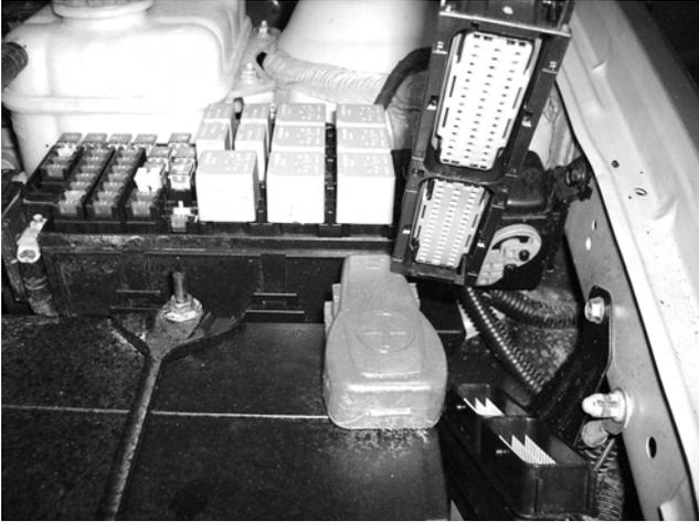
Отворачиваем ЭБУ от корпуса автомобиля вместе с креплениями. Вскрываем блок управления, видны потеки и даже, непосредственно вода.
