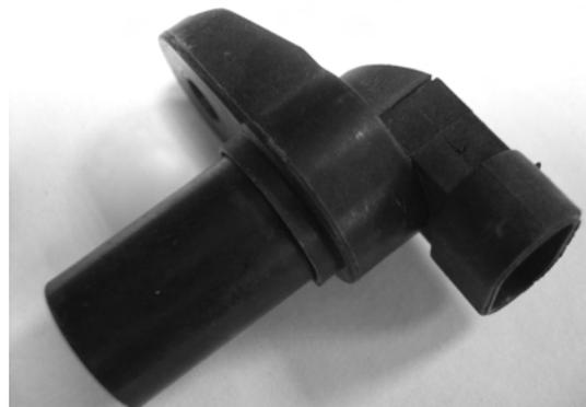
Неисправности в цепях датчика или его выход из строя легко определяются системой самодиагностики блока управления. В этом случае управляющая программа переходит на реализацию попарно-параллельного впрыска топлива, что сказывается на ездовых качествах автомобиля и его экономичности.
