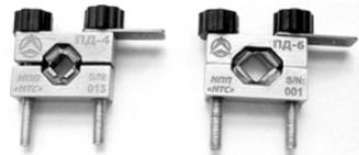
Преобразуют радиальную деформацию топлив. трубопровода высокого давления дизельного двигателя в электрический заряд. Используются как первичные преобразователи для отметки момента начала впрыскивания топлива в дизельных стробоскопах и оценки характера изменения давления в топливопроводе.
