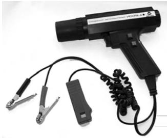
Стробоскоп автомобильный Искра-А предназначен для определения частоты вращения коленчатого вала двигателя и регулировки угла опережения зажигания (УОЗ) в автомобилях с карбюраторными и инжекторными двигателями, оснащенных системой зажигания с распределителем.
