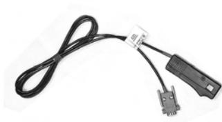
Клещи подключаются к высоковольтному проводу первого цилиндра на автомобилях с классической схемой системы зажигания и формируют импульсы начала отсчета в режимах, где необходим счет цилиндров.
