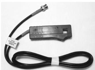
Клеши подключаются к высоковольтному проводу первого цилиндра на автомобилях с классической схемой системы зажигания и формируют импульсы начала отсчета в режимах, где необходим счет цилиндров.
