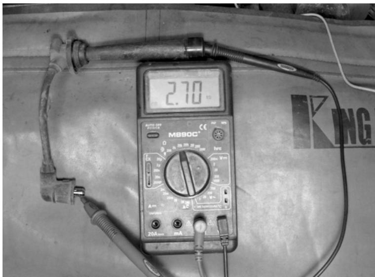
Разница в сопротивлении, зависит от длины высоковольтного провода.
