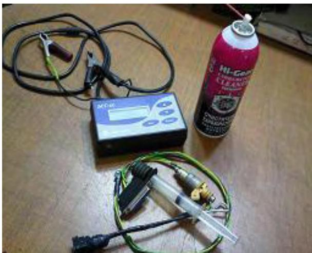
Подключаем к ДСТшке питание и наш «стенд для промывки форсунок».
