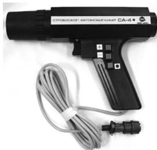
Стробоскоп для работы с АМД-4АК для определения углов опережения зажигания.
