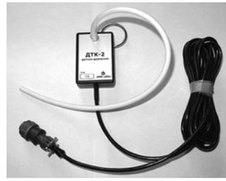
Для измерения давления воздуха во впускном и выпускном коллекторе двигателя, давления наддува турбины, просмотра пульсаций давления. Позволяет определить работоспособность турбины двигателя,
