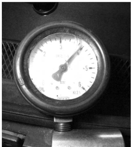
Заводим автомобиль, проверяем давление топлива, показания манометра в норме.
