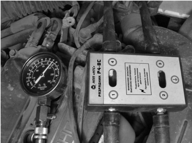
Замер давления топлива при помощи манометра топливной рампы МТА-2ИР и его модификаций. Используется доработанный переходник – тройник для автомобилей ГАЗ. Для разъединения топливопровода, применяются съемники и их модификации.
