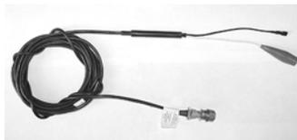
Для усиления сигнала с ПД-4, ПД-6 и передачи его в блок АМД-4Д. Позволяет посмотреть форму сигнала давления в трубках топливной системы ТНВД дизельных двигателей и сделать выводы о работоспособности ТНВД и форсунок, определить угол момента впрыска и длительность открытого состояния форсунки.
