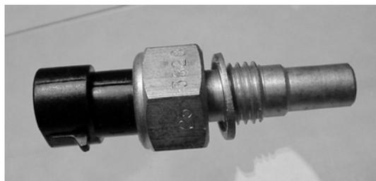
Этот датчик – самый надежный из всех датчиков системы российского производства. По этому датчику система определяет тепловое состояние двигателя и принимает решение о коррекции параметров (обороты ХХ, обогащение подачи топливной смеси, угол опережения зажигания, включение - выключение вентилятора и т.д.).
