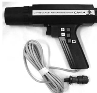
Стробоскоп для работы с АМД-4Д для определения углов опережения зажигания.
