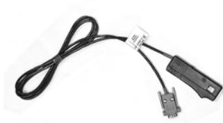
Для измерения абс. давления воздуха во впускном и выпускном коллекторе двигателя, давления наддува турбины, просмотра пульсаций давления, оценки работоспособности турбины двигателя, состояния нейтрализатора выхлопных газов и газораспред. механизма. Диапазон измерения статич. давления 20...304 кПа. Диапазон измерения пульсаций давления -7...+7 кПа
