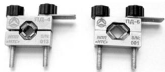
Пьезодатчики ПД-4, ПД-6 предназначены для преобразования радиальной деформации топливного трубопровода высокого давления дизельного двигателя в электрический заряд. Используются как первичные преобразователи для отметки момента начала впрыскивания топлива в дизельных стробоскопах и оценки характера изменения давления в топливном трубопроводе в измерительных системах диагностики дизелей.
