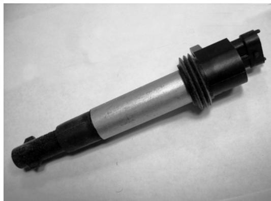
На 16V двигателях устанавливаются четыре отдельных катушки зажигания. Катушка также, как и четырехвыводная имеет трех контактный разъем. На схеме мы видим, что контакты 1 и 3 это первичная обмотка. На 3 контакт подключено напряжение бортсети
