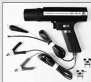
Приборы для диагностики дизельных автомобилей: дизельный стробоскоп-тахометр ДСУ-2, пьезоэлектрические датчики пульсации давления ПД-4, ПД-6.
