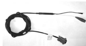
Для усиления сигнала с ПД-4 и ПД-6 и последующей передачи усиленного его в АМД-10СО. Позволяет посмотреть форму сигнала давления в трубках топливной системы ТНВД дизельных двигателей и сделать выводы о работоспособности ТНВД и форсунок, определить угол момента впрыска и длительность открытого состояния форсунки.
