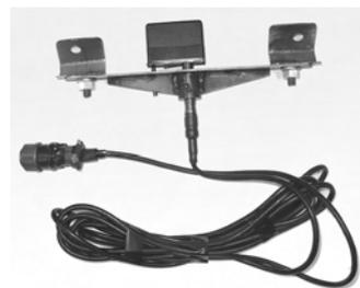
Датчик оптический коленчатого вала ОДК-2 используется в диагностике дизельных двигателей КАМАЗ. Предназначен для привязки сигналов с других датчиков к углу поворота коленвала диагностируемого двигателя.
