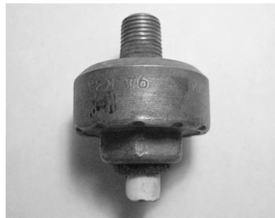
Система гашения детонации в автомобиле позволяет гибко корректировать угол опережения зажигания в двигателе, работа которого по каким-то причинам отличается от нормальной. К таким причинам относятся и плохое топливо и регулировка клапанов, сбои в системе охлаждения и т.д.
