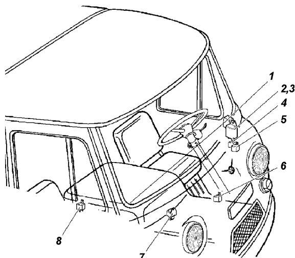
Рис. 9.37 Расположение реле и блока предохранителей
