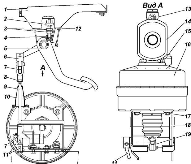
Рис. 9.34. Привод главного тормозного цилиндра:
