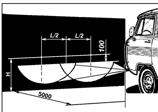
Рис. 9.43. Разметка экрана для регулировки противотуманных фар:
