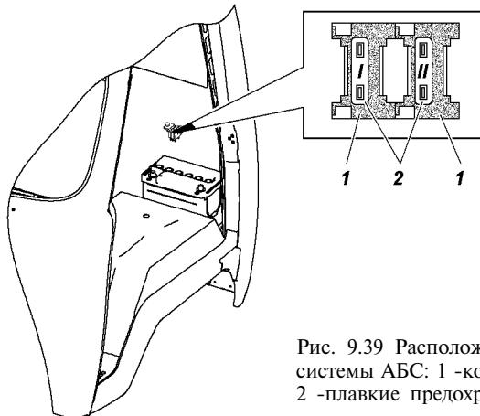
Рис. 9.39 Расположение предохранителей системы АБС: 1 - колодка предохранителя; 2 - плавкие предохранители (см. таблицу)
