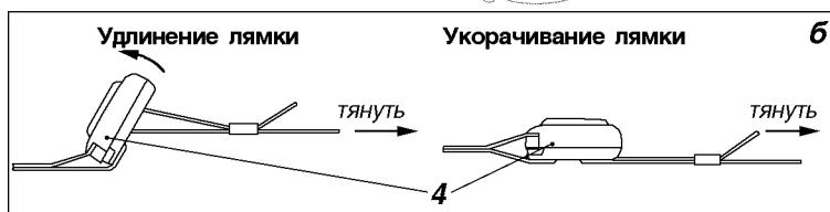
Рис. 3.8. Ремни безопасности салона автомобиля УАЗ-390995, УАЗ-390945: 1 -язычок; 2 -замок; 3 -кнопка замка; 4 -регулятор поясного ремня
