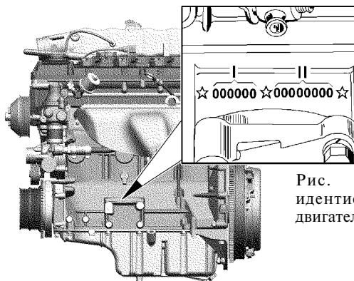
Рис. 1.9. Расположение идентификационного номера двигателя ЗМЗ-40911
