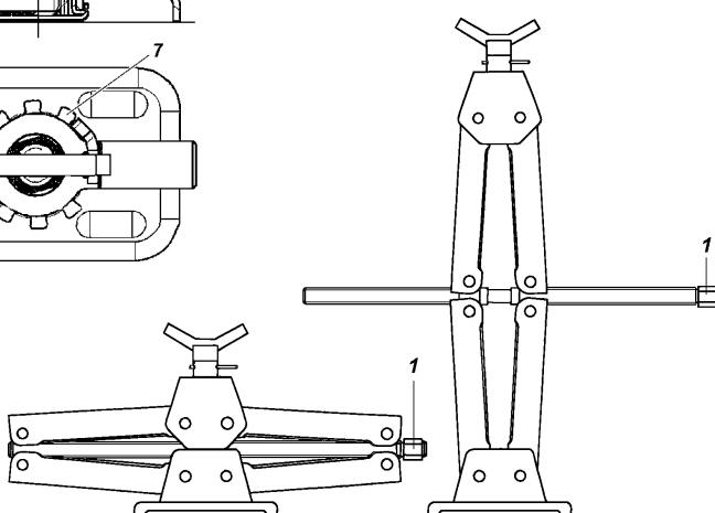
3. Поднимайте колесо автомобиля на необходимую высоту, вращая шестигранник 1 домкрата по часовой стрелке с помощью ключа для гаек колес;
