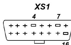
Рис. 9.11. Диагностический разъем (XS1)
