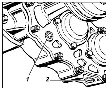
Рис. 9.15. Пробки раздаточной коробки:
