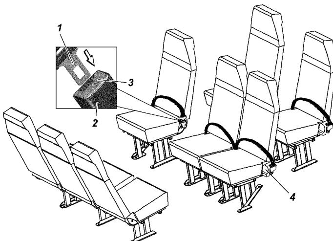
Рис. 3.7. Ремни безопасности салона автомобиля УАЗ-220695: 1 -язычок; 2 -замок; 3 -кнопка замка; 4 -инерционная катушка
