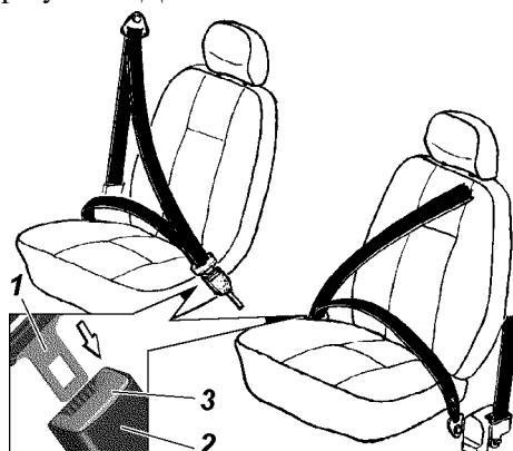
Рис. 3.6. Ремни безопасности: 1 -язычок; 2 -замок; 3 -кнопка замка
