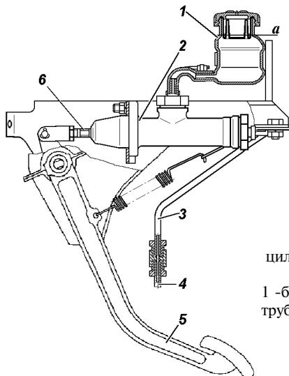
Рис. 9.13. Привод главного цилиндра выключения сцепления:
