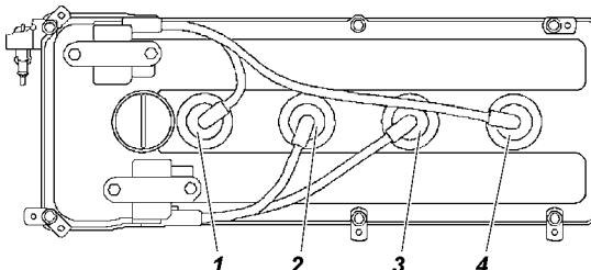
Рис. 9.8. Порядок установки высоковольтных проводов:
