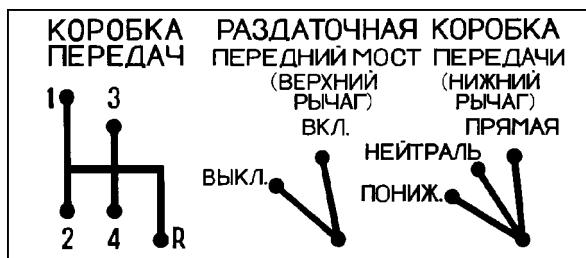
Рис. 3.4. Схема положений рычагов коробки передач и рычагов раздаточной коробки
