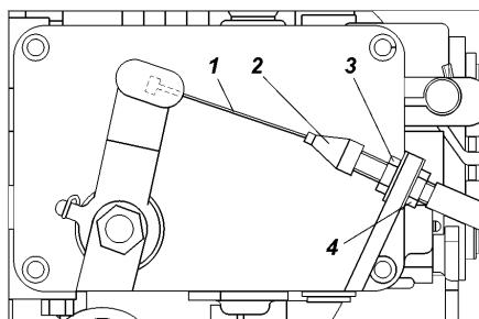
Рис. 9.38. Регулировка привода педали акселератора:
