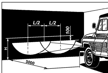
Рис. 9.65. Разметка экрана для регулировки противо-туманных фар:
