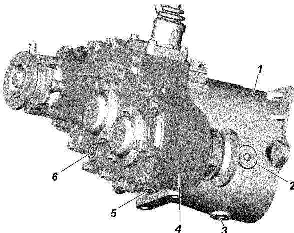
Рис. 9.43. Четырехступенчатая коробка передач и раздаточная коробка:
