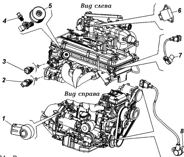
Рис. 9.24. Расположение датчиков на двигателе ЗМЗ-409 (Экологический класс 2):
