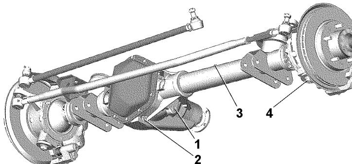
Рис. 9.45. Передний мост с неразъемным картером:
