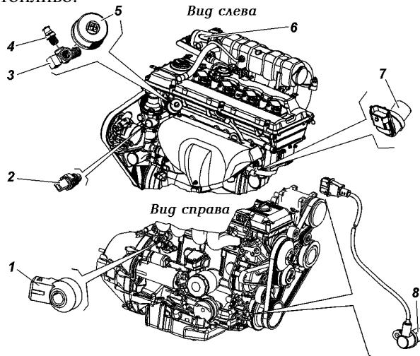
Рис. 9.25. Расположение датчиков на двигателе ЗМЗ-409 (Экологический класс 3):
