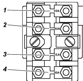
Рис. 9.67. Блок силовых плавких предохранителей автомобиля
