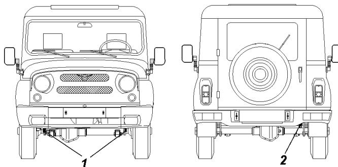
Рис. 8.1. Буксирные проушины и тягово-цепное устройство:
