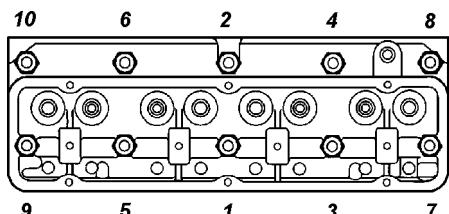
Рис. 9.1. Порядок подтяжки гаек головки блока цилиндров
