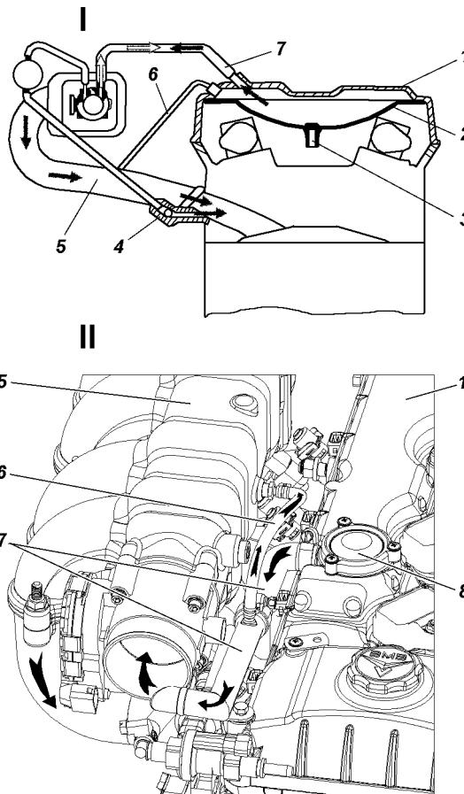
Рис. 9.21. Вентиляция картера двигателя ЗМЗ-409:
