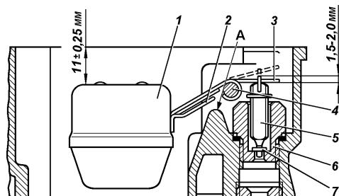
Рис. 9.9. Поплавок карбюратора и его регулировка:
