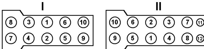
Рис. 9.18. Последовательность затяжки болтов крепления головки блока цилиндров
