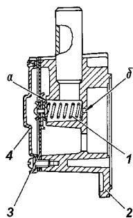
Рис. 9.6. Регулятор разрежения:
