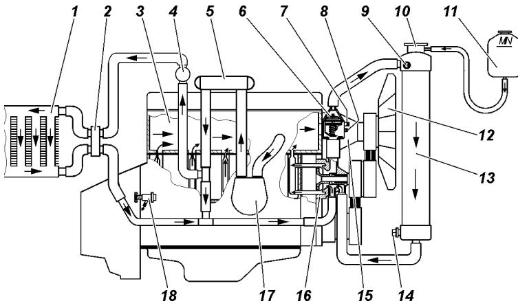
Рис. 9.32. Схема системы охлаждения двигателя:
