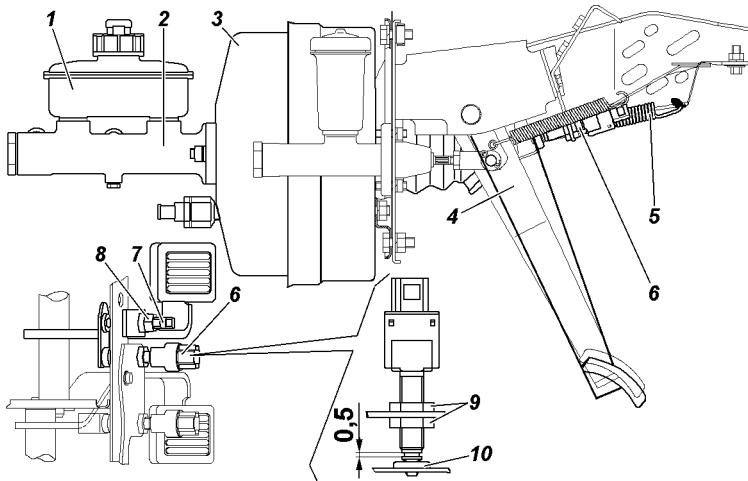
Рис. 9.60. Привод главного цилиндра:
