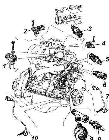
Рис. 9.23. Расположение датчиков на двигателе УМЗ-4213:
