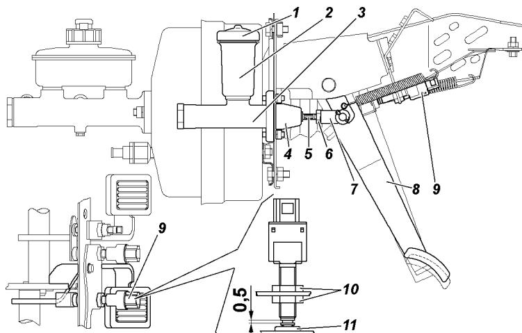
Рис. 9.40. Привод главного цилиндра выключения сцепления:
