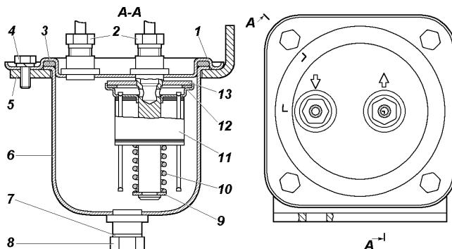
Рис. 9.7. Топливный фильтр-отстойник:
