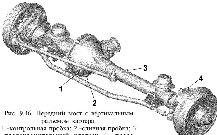
Рис. 9.46. Передний мост с вертикальным
