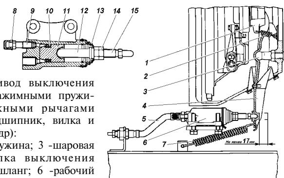
Рис. 9.41. Привод выключения сцепления с нажимными пружинами и оттяжными рычагами (выжимной подшипник, вилка и рабочий цилиндр):
