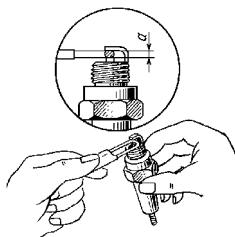
Рис. 9.15. Замер зазора между электродами свечи зажигания:
